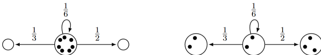
Obrázek 1: Chip firing: vrchol před střelbou a po střelbě (*střelba = posun žetonků)
